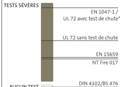
\* La norme UL 72 n'impose pas nécessairement le test de chute mais nous l'exigeons.
